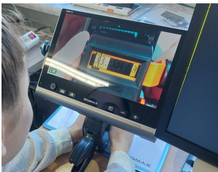
Rysunek 2. Przenośna lupa elektroniczna umożliwiająca pracę z metkownicą, której obsługa niezbędna jest do zaliczenia egzaminu zawodowego
